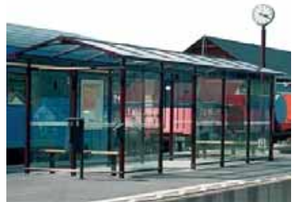
En esta estación de tren se ha usado la placa Lexan Margard* por su resistencia a los impactos, a la abrasión y al posible vandalismo
